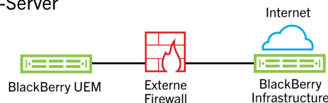
Option 2 – In der DMZ bereitgestellter TCP-Proxy-Server
